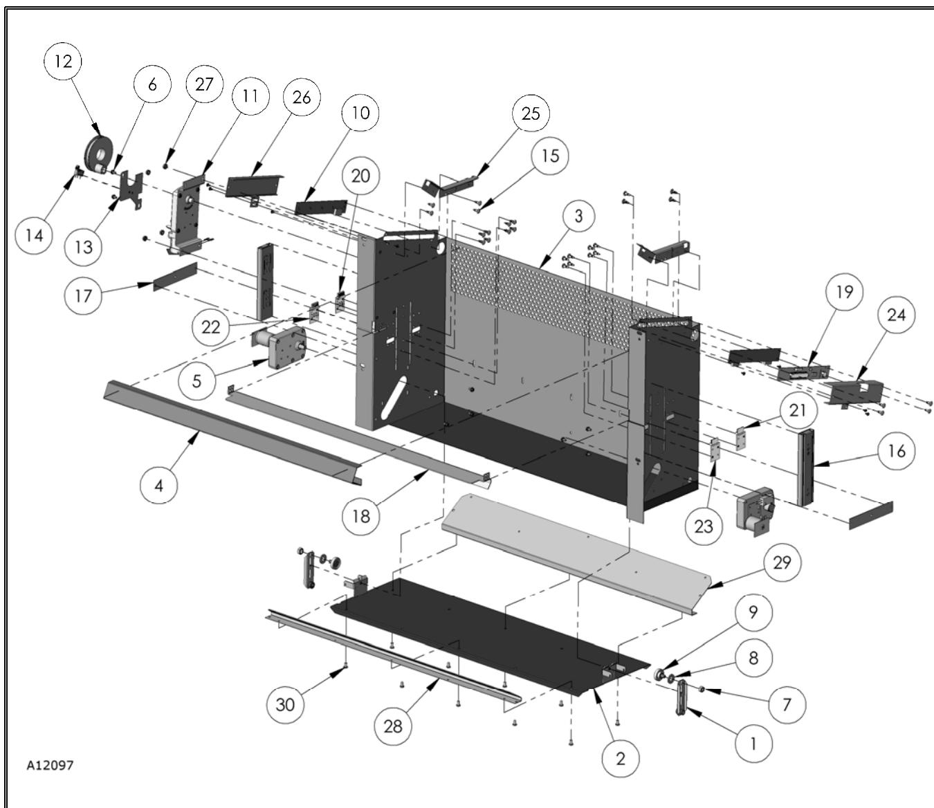
**DELIVERY BOX ASSEMBLY WITH LIFT PARTS LIST**
